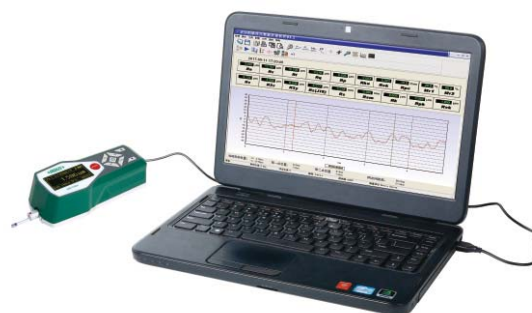
通过USB线连接电脑(软件标配), 电脑上显示粗糙度测量数据、粗糙度轮廓和曲线
