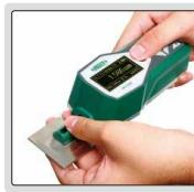
可将微小工件直接压在测头上测量
