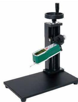
可测量的工件最大高度为220mm
